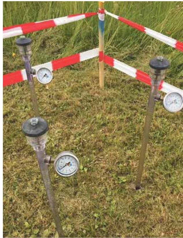
Mit Tensiometern wird zurzeit die Bodenfeuchte und -spannkraft gemessen und der Baustart zum Golfplatz in Meggen festgelegt.
