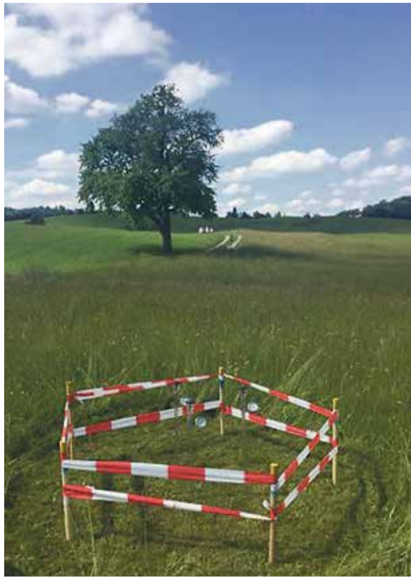
Mit Tensiometern wird zurzeit die Bodenfeuchte und -spannkraft gemessen und der Baustart zum Golfplatz in Meggen festgelegt.
